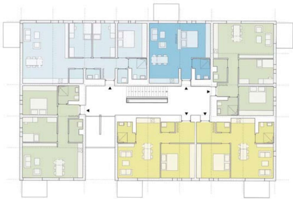
Der Modulbaukasten mit seinen Standard-Grundrissen – hier ein Grundriss für ein Regelgeschoss – steht GdW-Mitgliedern in einer bundesweiten Rahmenvereinbarung zum seriellen Bauen zur Verfügung. Schon bei den drei vom Bauhaus realisierten Meisterhäusern in Dessau waren die Grundrisse identisch. Allerdings wurde jeweils eine der drei Doppelhaushälften um 90 Grad gedreht.
