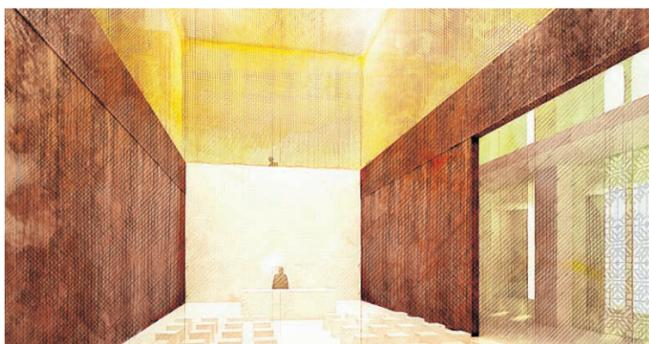
Neuer Sakralbereich als Raum-in-Raum Konzept mit aufklappbaren Seitenwänden zu den Seitenschiffen und gitterartiger, offener Deckenkonstruktion.
